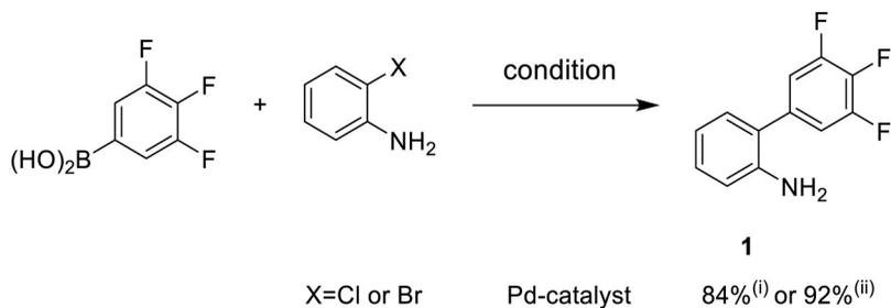
(i)  $(\text{PPh}_3)_2\text{PdCl}_2$  (3 mol%),  $\text{K}_2\text{CO}_3$ , dioxane,  $\text{H}_2\text{O}$ ,  $70\text{ }^\circ\text{C}$ , 3 h. (ii)  $\text{Pd}(\text{PPh}_3)_4$  (5 mol%),  $\text{K}_2\text{CO}_3$ , THF,  $\text{H}_2\text{O}$ ,  $70\text{ }^\circ\text{C}$ , 16 h.
