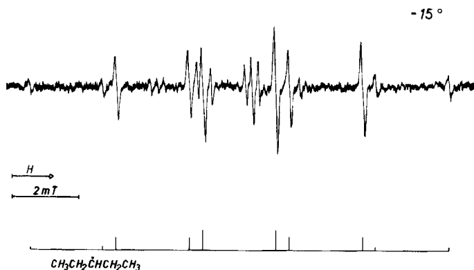
Fig. 7. ESR.-Spektrum freier Radikale während der Bestrahlung von \text{CH}_3\text{COCH}(\text{C}_2\text{H}_5)_2 in Methylcyclopentan.
