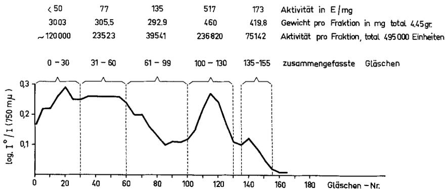
Fig. 4. *Gegenstrom-Verteilung des Cyclisierungs-Rohproduktes* System n-Butanol/Pyridin/Eisessig/Wasser (40:10:5:45); 178 Stufen 5 g oder 565 000 Einheiten
